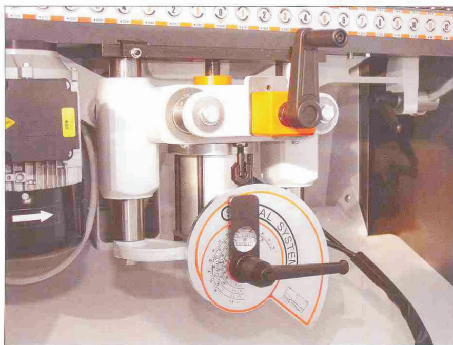
Pracovní jednotka při vrtání do plochy
