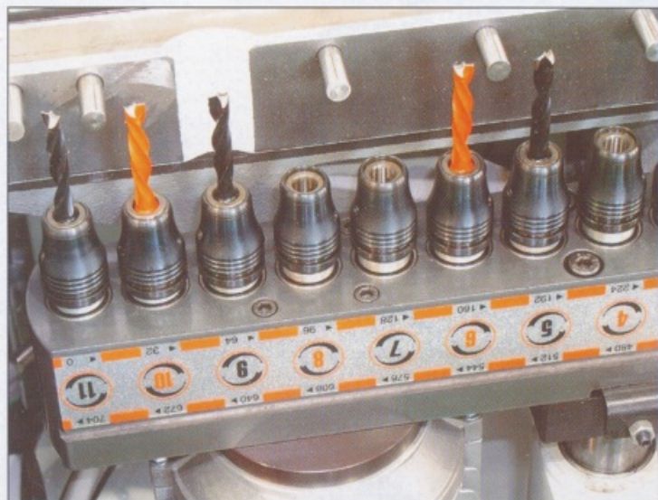
Pevná upínací pouzdra na vřetenech a čtyřpolohový doraz pro vymezení výchozí pozice vřeteníku
