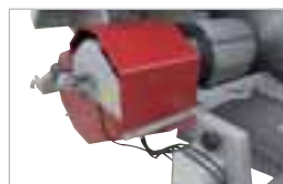
Pohon výkonným elektromotorem s výkonem 7,5 kW P 1 S6 40% ED (WTK 710 EZ)
