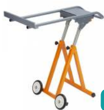
Manipulační vozík na desky PM-1850 ■ podávací rameno 90° ■ nastavitelná výška od 71 do 97 cm ■ nosnost 160 kg ■ obj. č. 233104
